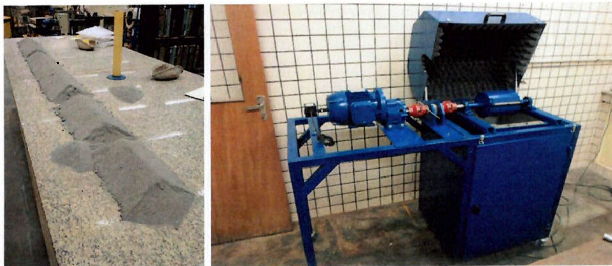
Figura 7 - Pilha de homogeneização da amostra, proveta (esquerda) e moinho de torque (direita)
